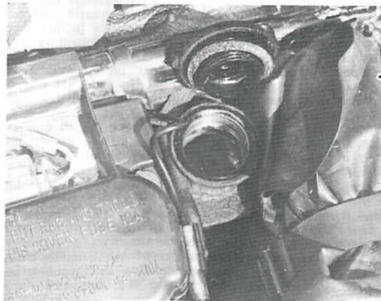
**Nota.** — Ne pas débrancher les tubulures d'huile, sinon des bulles d'air risquent de parvenir à la pompe occasionnant des défauts d'alimentation. On remédie à cet incident en purgeant le circuit comme indiqué plus loin dans le paragraphe « Pompe à huile ». Les réglages de débit et de synchronisation de la pompe à huile sont décrits au même paragraphe.
