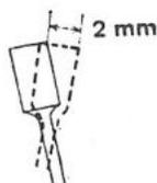
On peut vérifier globalement le jeu à la tête de bielle en la déplaçant latéralement, le jeu ne doit pas excéder 2 mm
